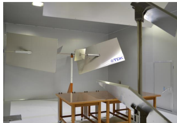
メーカーと共同開発を行った 国産初のEMC施設 リバレーションチャンバー
